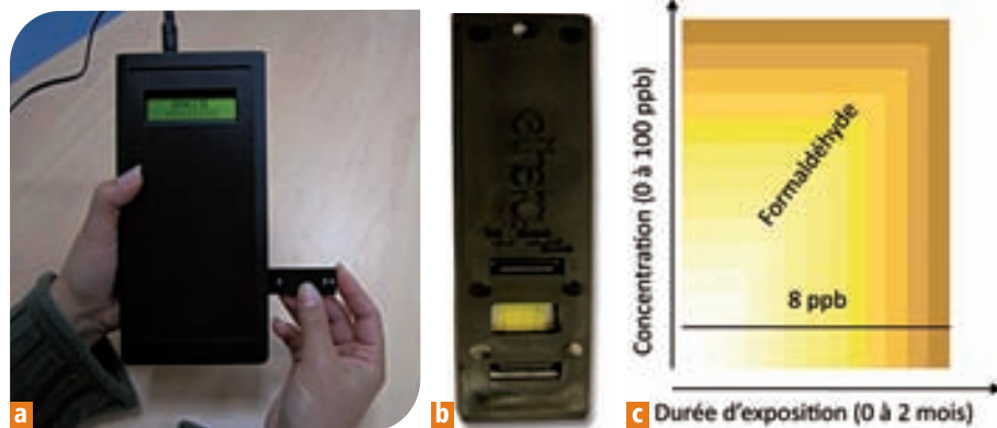
Figure 3. a. Introduction du capteur exposé au polluant dans le lecteur digital équipé d'une diode électroluminescente. b. Zoom sur le capteur dont la coloration jaune indique le piégeage de formaldéhyde. c. Nuancier de couleur pour une évaluation de la teneur en formaldéhyde en fonction de la durée d'exposition.
