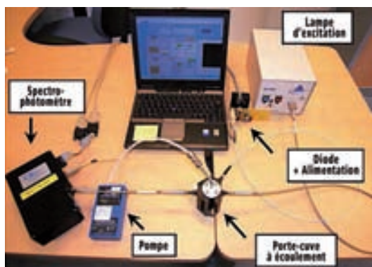
Figure 2. Prototype de laboratoire comportant une micro-pompe, deux sources lumineuses (lampe et LED), une cuve à écoulement (en quartz ou verre) dans lequel est positionné le capteur (film mince ou monolithe). La cuve à écoulement est insérée dans un porte-cuve muni de 3 entrées optiques pour l'excitation des capteurs et la transmission de la lumière émise (Fluo) ou transmise (absorption) vers le spectrophotomètre miniature Ocean Optics. a. Mesure de la variation de l'aire de fluorescence de la DDL entre 480 et 600 nm en fonction de la concentration de formaldéhyde pour un temps d'exposition de 3 min à un flux de 220 mL.min -1 . b. Mesure de la variation d'absorbance de la DDL en fonction du temps d'exposition d'un monolithe dopé de Fluoral-P à une teneur constante de formaldéhyde (40 ppb, flux : 220 mL.min -1 ).
